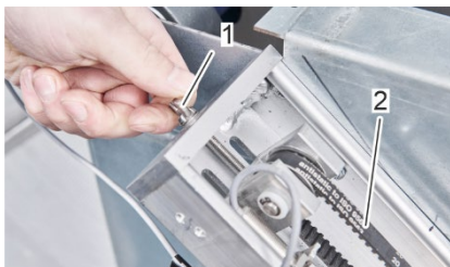
Fig. 33: Loosen the wing nut
